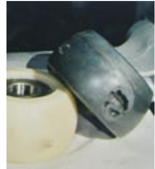
Defekte Kuppelrolle durch Gussfehler und einseitige Abreibung
