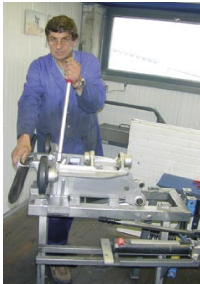
Ossi Haller, Gondelbox EUB. Mit Hilfe eines Drehmomentschlüssels müssen alle Schrauben auf festen Sitz kontrolliert werden.
